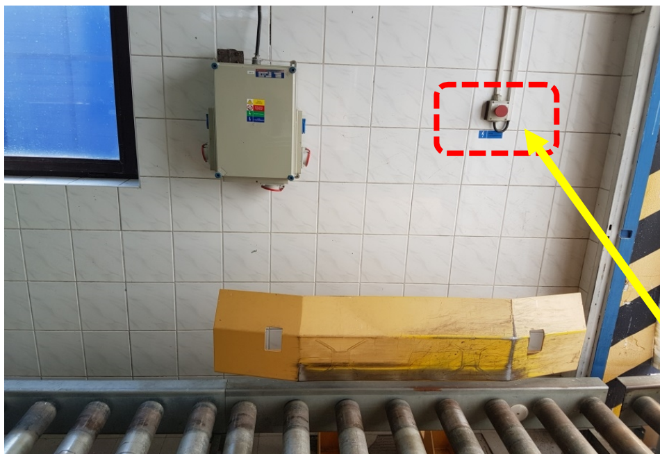
Obr. 3 Nesprávne nainštalované tlačidlo núdzového vypnutia (prístup k jeho ovládaniu je znemožnený dopravným pásom, ktorý je v nepretržitej prevádzke)
