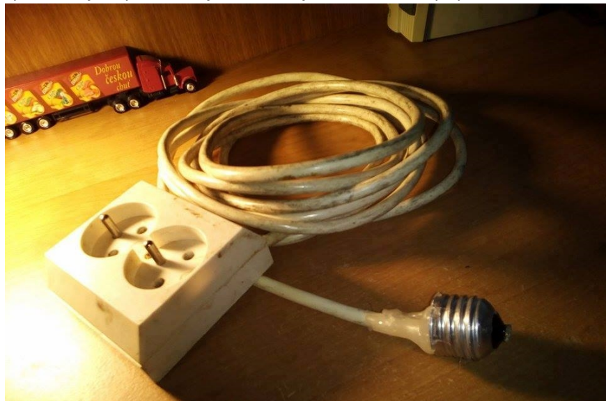
Obr. 1 Neodborne vyrobená predlžovacia pohyblivá šnúra do svetelného telesa/žiarovkovej objímky na 230 V
