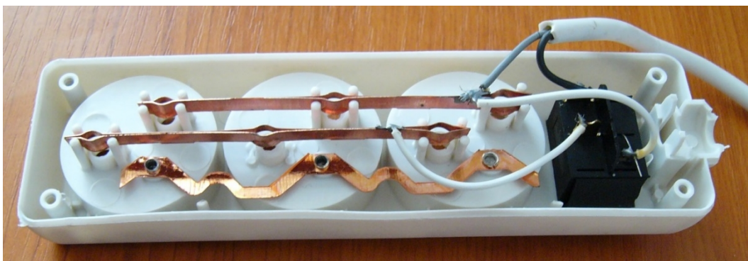
Obr. 4 Nevyhovujúci predlžovací šnúrový prívod - dvojšnúrový (chýba vodič PE).
