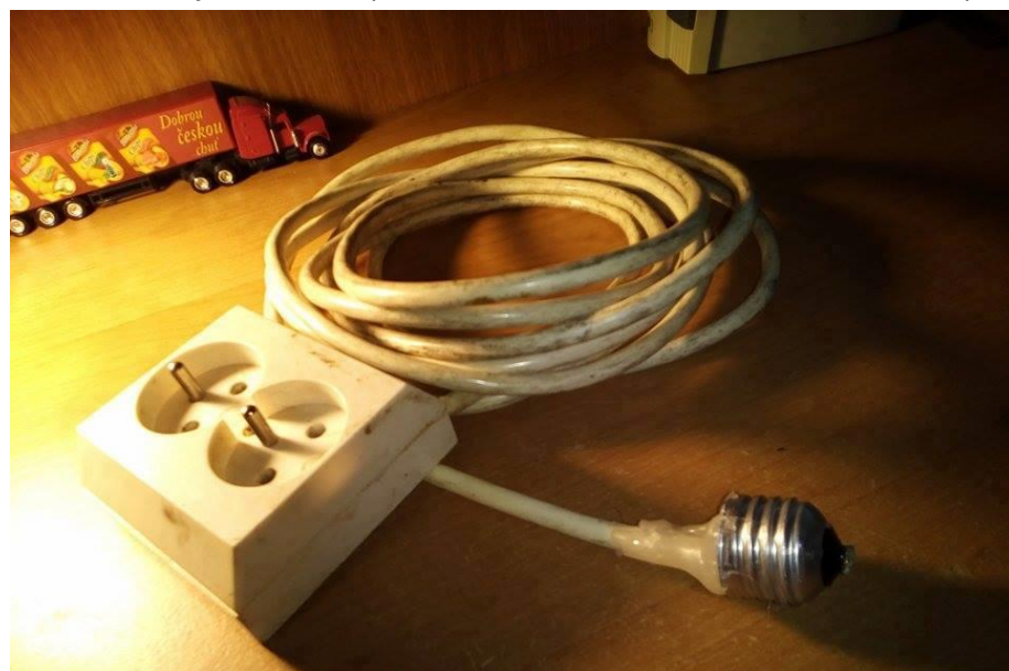
Obr. 1 Neodborne vyrobená predĺžovacia pohyblivá šnúra do svetelného telesa/žiarovkovej objímky na 230 V
