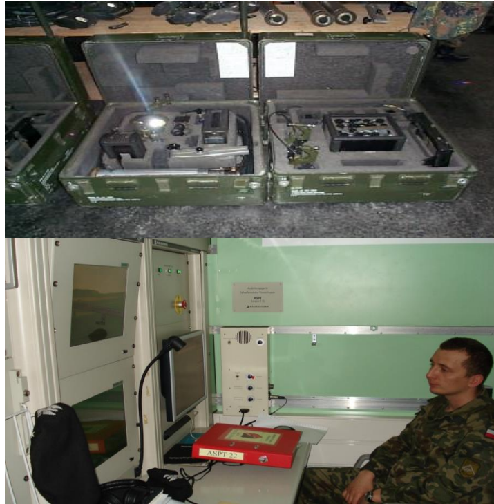
Zdjęcie 7. Symulator szkolenia taktycznego plutonu czołgów Leopard 2A4 typu „AGPT”
