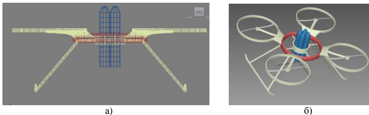
Рисунок 1 Система мониторинга территорий в зоне ЧС на базе беспилотного варианта квадрокоптера: а) вид слева, б) вид сверху
