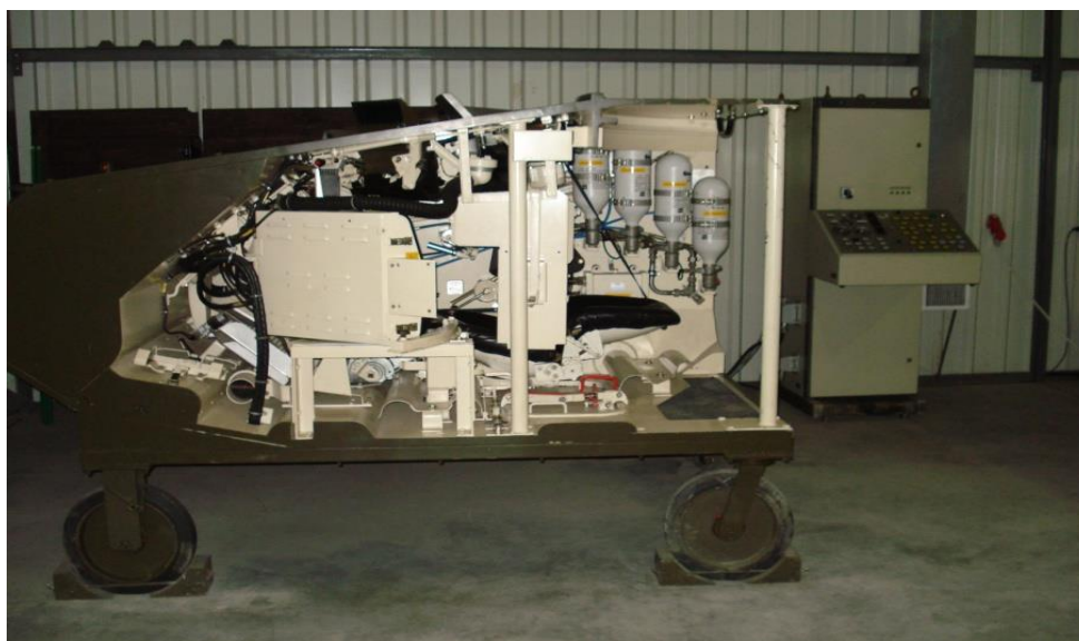
Zdjęcie 5. Trener szkolenia kierowców czołgu Leopard 2A4 typu „STEND”
